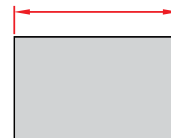
Минимальная ширина заготовки 50 мм Минимальная длина заготовки 150 мм
