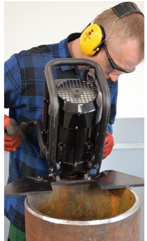
Снятие фаски на трубе
