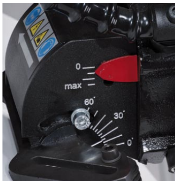
Плавная регулировка угла фаски от 0° до 60°
